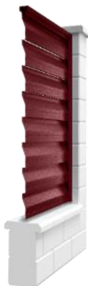
Secțiune panou gard cu bolțari
